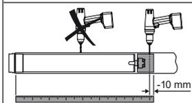
Um eine sichere Übertragung des Drehmomentes bei **Rundwellen** sicherzustellen, empfehlen wir den Mitnehmer mit der Welle zu verschrauben (siehe nachfolgende Tabelle).
