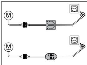
Das automatische Einstellen der Endlagen bei Verwendung von beidseitigen Anschlagssystemen ist mit dem Knebelschalterset (Art.-Nr. 4901 001 158 0), einem handelsüblichen Knebelschalter oder dem Einstellset für Antriebe mit elektronischer Endabschaltung (Art.-Nr. 4935 200 011 0) möglich. Alle anderen Funktionen sind ausschließlich mit dem Einstellset einstellbar.
